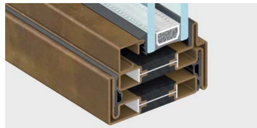
nodo inferiore | sezione in vista 47 mm
