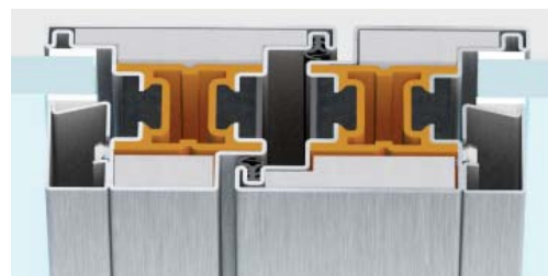
nodo centrale | sezione in vista 156 mm
