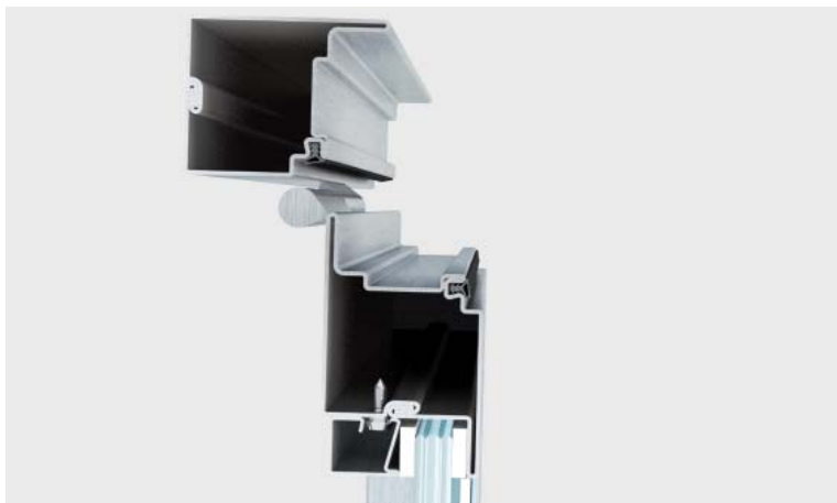
nodo laterale | sezione in vista 131 mm
