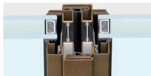
nodo centrale | sezione in vista 62 mm
