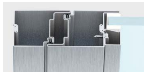
nodo laterale | sezione in vista 131 mm
