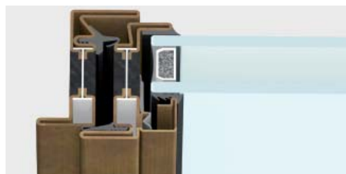
nodo laterale | sezione in vista 47 mm
