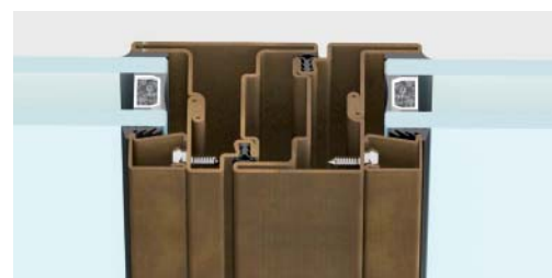
nodo centrale | complanare | sezione in vista 101 mm
