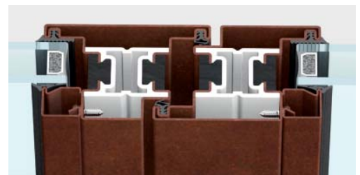
nodo centrale | sezione in vista 156 mm
