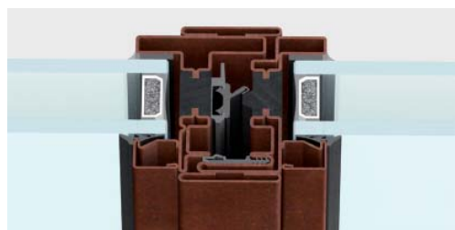
nodo centrale ridotto** | sezione in vista 85 mm
