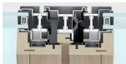
nodo centrale | sezione in vista 145 mm
